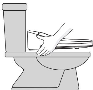
4. Приподнимите устройство и открутите пробку сливного отверстия (будьте осторожны, чтобы не потерять ее), сплейте воду полностью. Не рекомендуется переворачивать или сильно наклонять биде во избежание поломок устройства.
