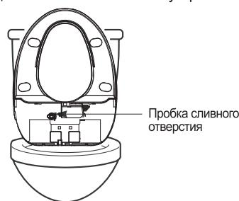
5. Закрутите пробку и установите аппарат обратно. Смотрите раздел "Пробный пуск" перед тем как снова использовать устройство.
