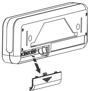
1. Откройте крышку отсека для батареек на пульте дистанционного управления и вставьте 3 AAA батарейки.
