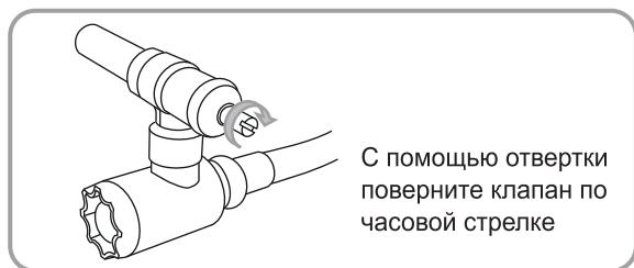
С помощью отвертки поверните клапан по часовой стрелке
