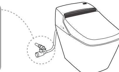
Если давление воды высокое, вода при чистке керамической чаши может разбрызгиваться или переливаться через край. Добейтесь уменьшения давления, регулируя клапан с помощью отвертки.
