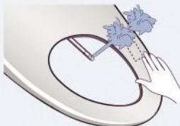
➤ Вода может не разбрьзгиваться сразу. Это связано с возможным образованием воздушной пробки в насосе, встроенном в бачок подогрева воды. Данного случай не считается дефектом или браком.
